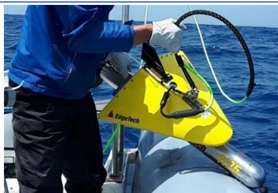
Foto 6. Ala depresora montada sobre el sonar Edgetech 4125.
