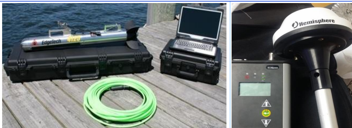
Foto 4. Sistema de SBL Edgetech 4125: sonar, unidad de adquisición de datos, cable de remolque/datos y DGPS Hemisphere.
