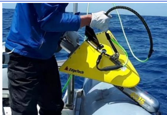
Foto 6. Ala depresora montada sobre el sonar Edgetech 4125.
