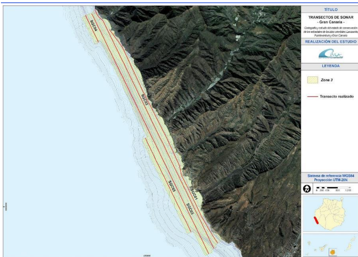
Figura 28. Transectos de sonar de barrido lateral realizados en la zona de sonar 3 de Gran Canaria.
