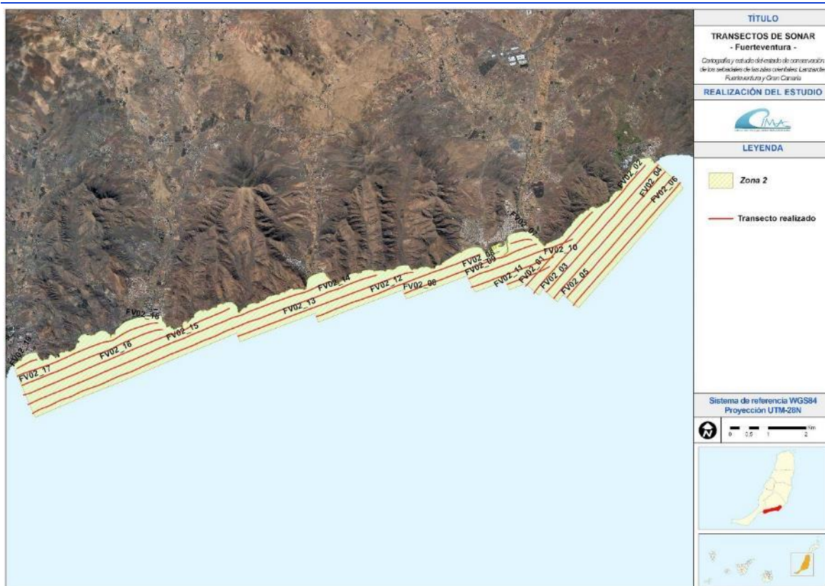
Figura 24. Transectos de sonar de barrido lateral realizados en la zona de sonar 2 de Fuerteventura.
