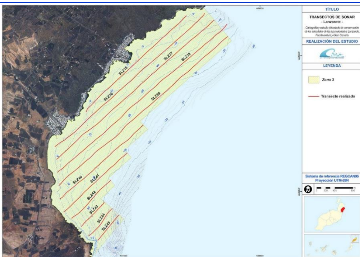
Figura 19. Transectos de sonar de barrido lateral realizados en la zona de sonar 3 de Lanzarote.
