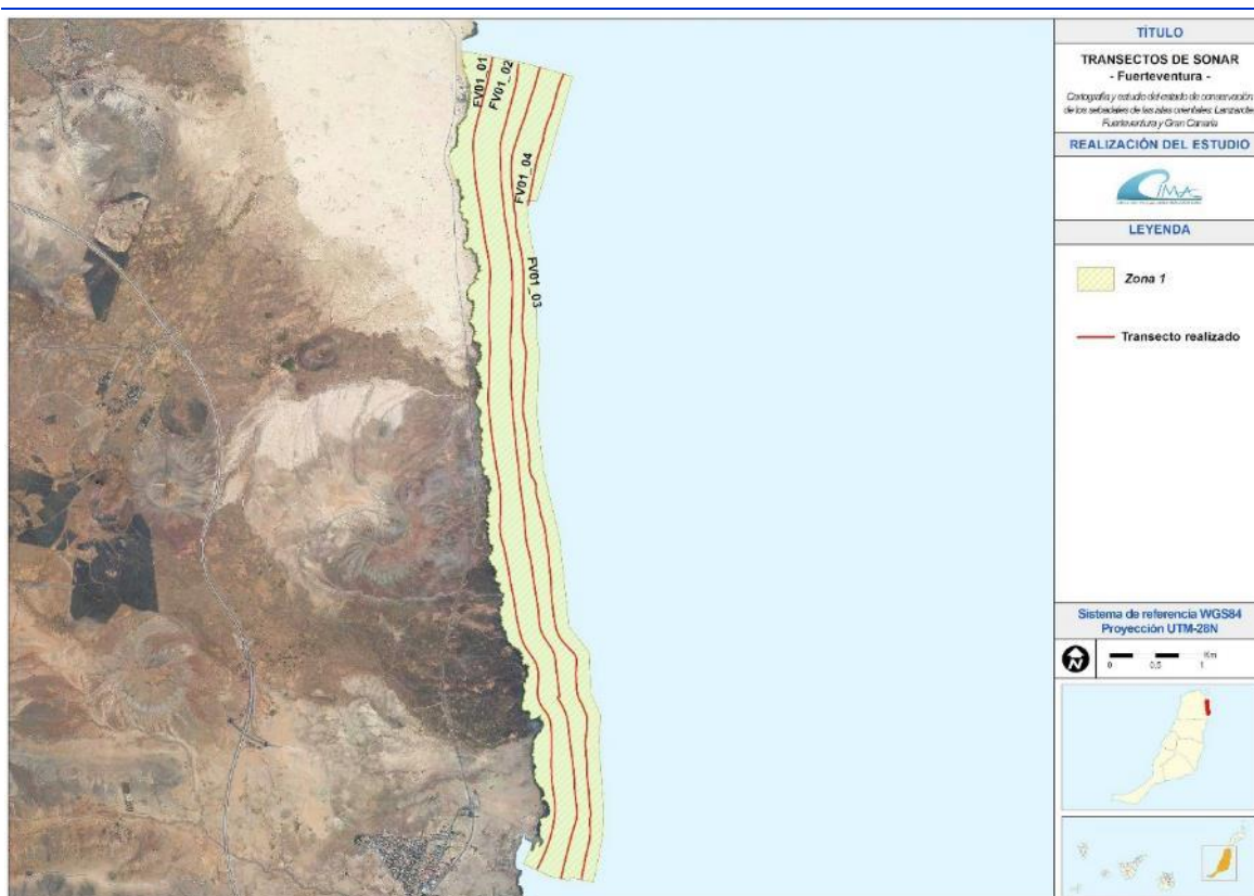
Figura 23. Transectos de sonar de barrido lateral realizados en la zona de sonar 1 de Fuerteventura.
