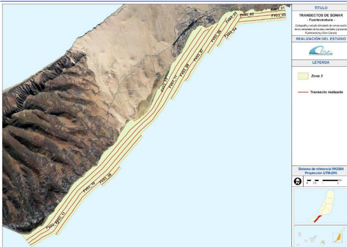
Figura 25. Transectos de sonar de barrido lateral realizados en la zona de sonar 3 de Fuerteventura.
