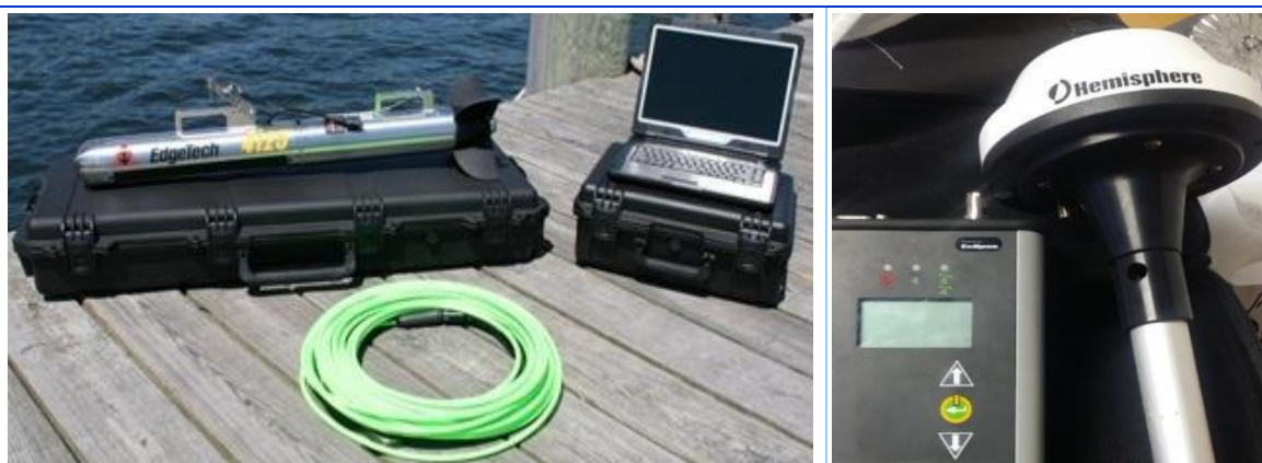
Foto 4. Sistema de SBL Edgetech 4125: sonar, unidad de adquisición de datos, cable de remolque/datos y DGPS.
