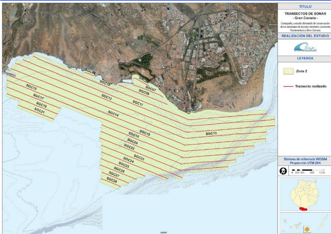
Figura 27. Transectos de sonar de barrido lateral realizados en la zona de sonar 2 de Gran Canaria.
