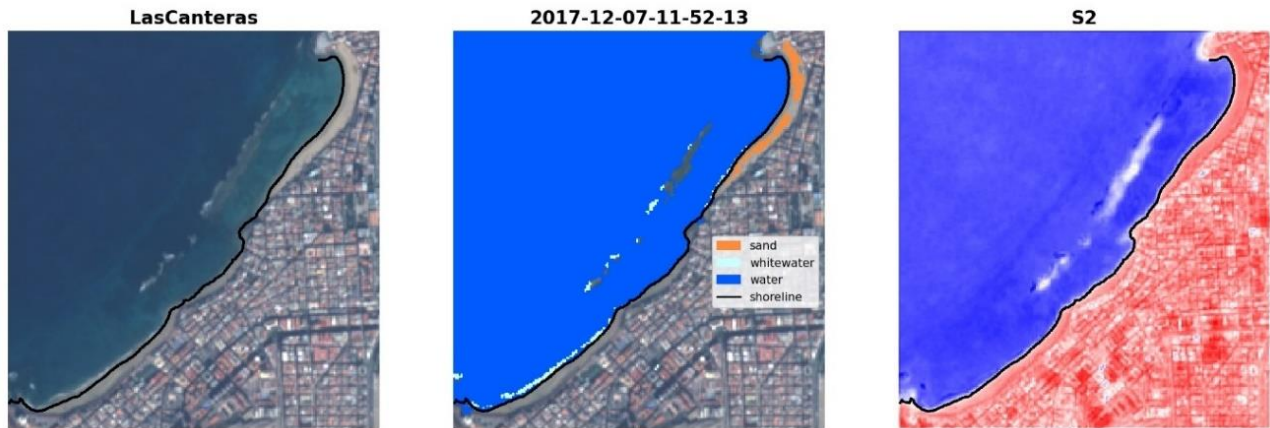
Figura 31. Detección de la línea de costa en la playa de las Canteras (Gran Canaria) a partir de una imagen de Sentinel 2 mediante el algoritmo Coast-Sat
